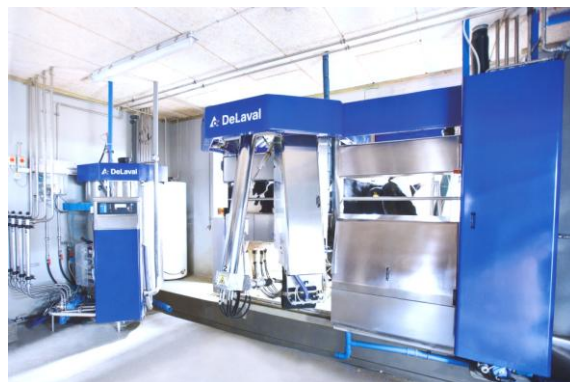
Рис. 2. Роботизованна доїльна установка фірми «De-Laval».
