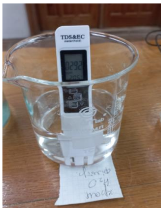
Рис. 3. Визначення вмісту солей у воді за допомогою TDS –метра.
