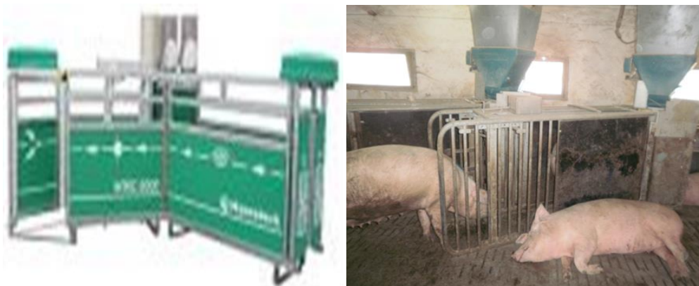
Рис. 1. Кормова станція для годівлі свиноматок.
