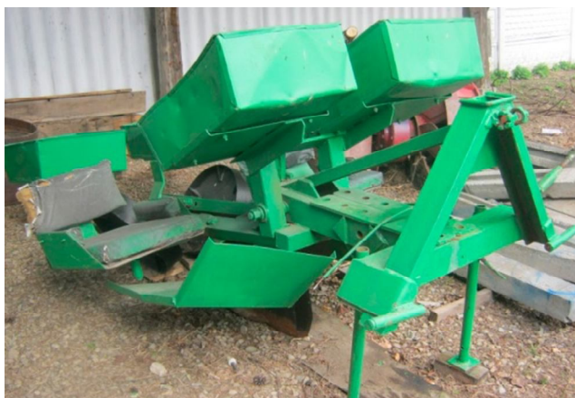
Рис. Лісова садильна машина з дводисковим сошником.
