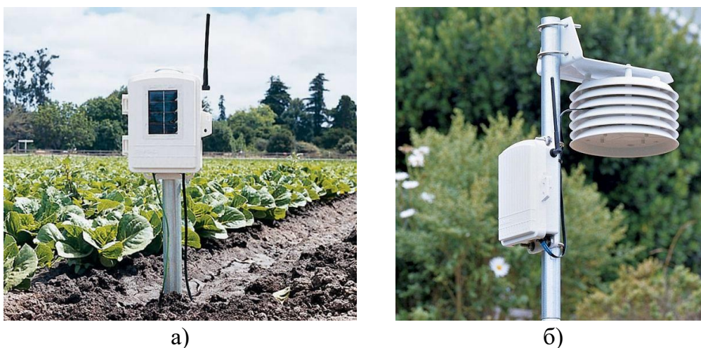
Рис. 1. Стаціонарні бездротові станції (компанії Davis Instruments, США) для моніторингу температури і вологості ґрунту(а) та повітря (б)
