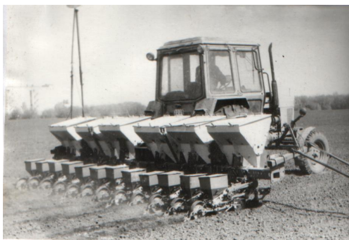
Рис. 1. Агрегат для посіву цукрових буряків з одночасним локальним внесенням товарного біогумусу в роботі.
