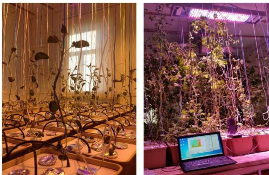
Рис. 7. Експериментальна аеропонна установка для багатофакторного експерименту.
