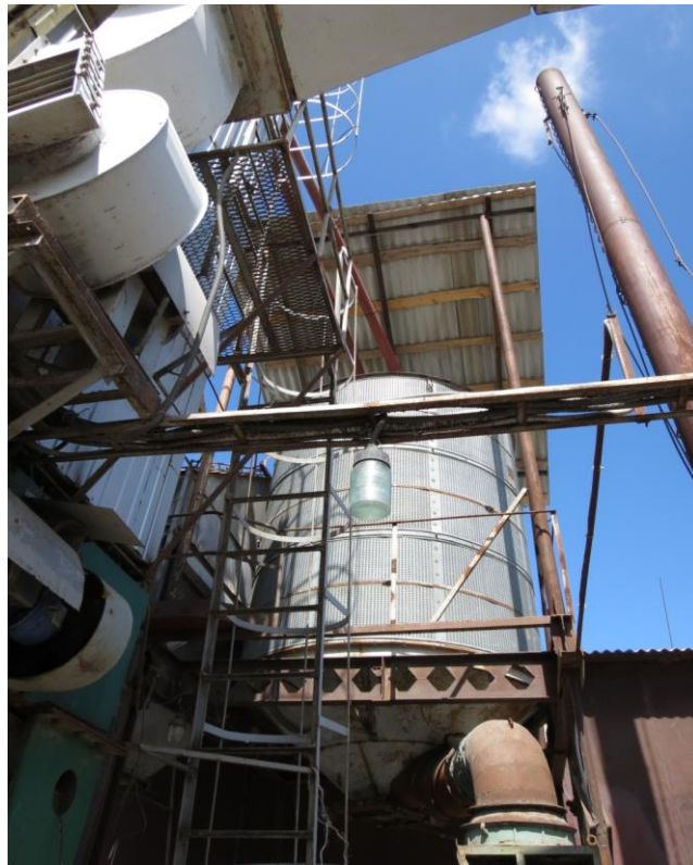
Рис. 3. Зерносушильний комплекс, оснащений прямопоточковим газогенератором (зерносушарка шахтного типу ЗШ – 1000)
