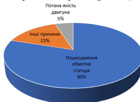
Рис. 1. Особливості несправностей асинхронних електродвигунів
