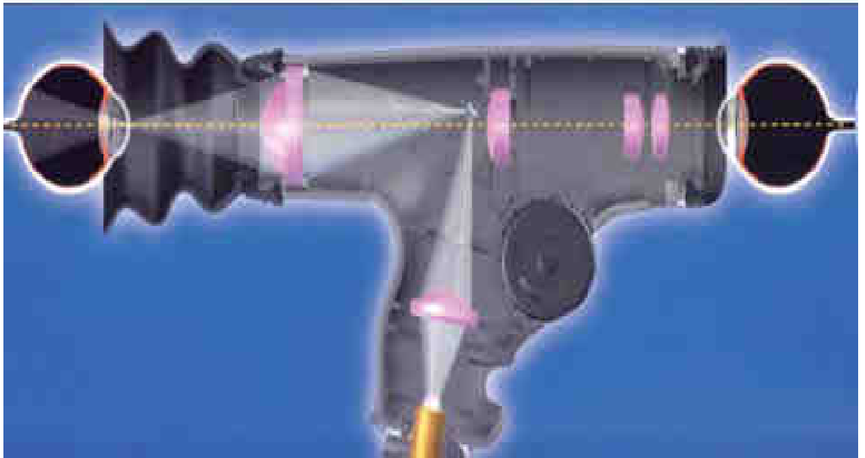
Рис. 3.6. Схема роботи офтальмоскопу PanOptic
