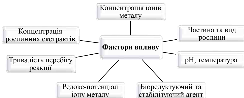
Рис. 1.3. Фактори, що впливають на «зелений» синтез наночастинок металів із рослинної сировини
