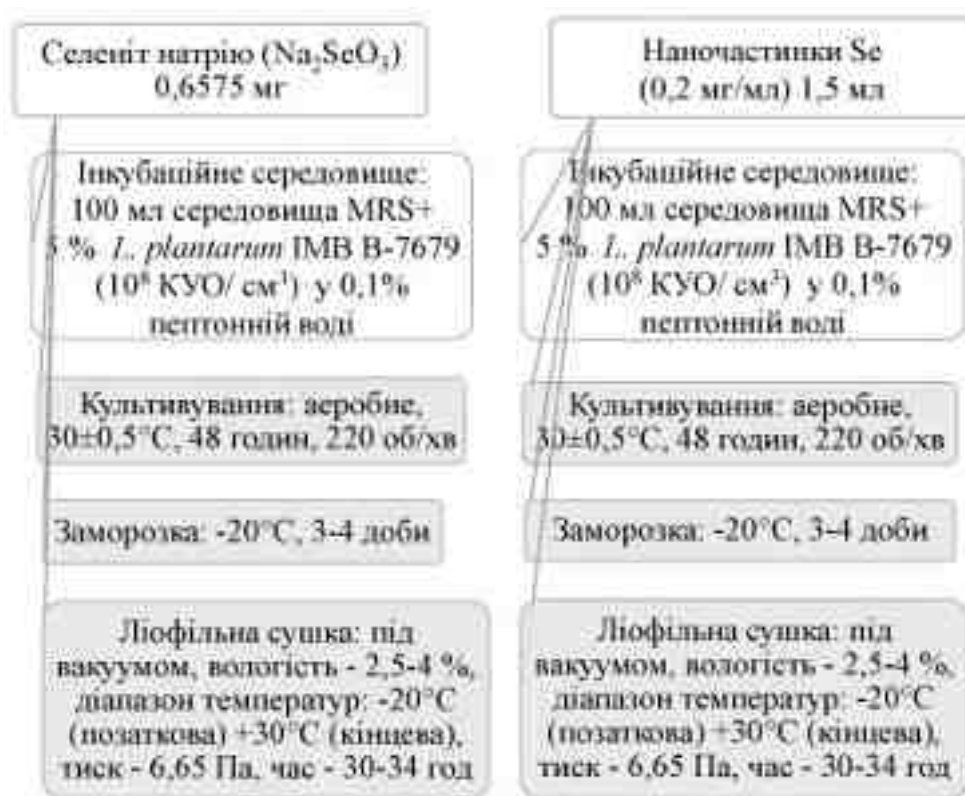
Рис. 3.4. Схема біотехнологічного синтезу біоаноселену
