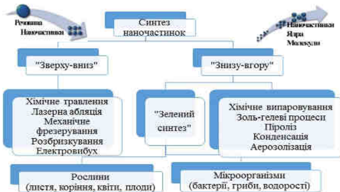
Рис. 1.2. Синтез наночастинок «зверху-вниз» і «знизу-вгору» [566]
