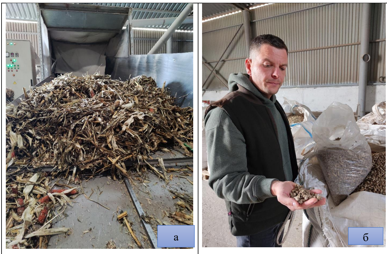
Рис. 5.8. Виготовлення паливних пелет з побічної продукції кукурудзи: а – завантаження в приймальне відділення прес-гранулятора ПП кукурудзи; б – паливні пелети з кукурудзи
