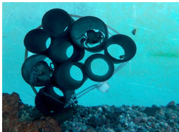
Рис. 3.2. Укриття із полімерних труб Ø 25 мм скріплених стяжками
