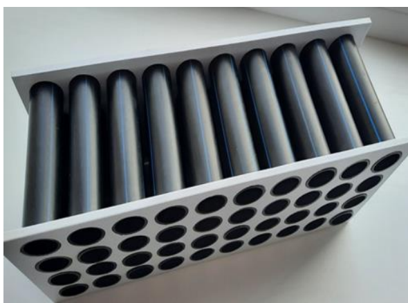
Рис. 3.4. Укриття із полімерних труб Ø 25 мм скріплених стяжками
